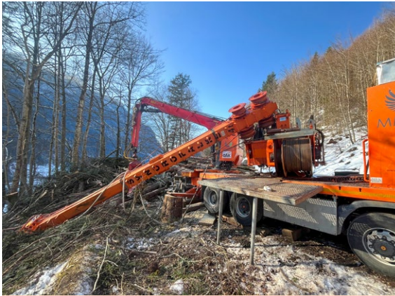
Nicht alles läuft immer wie geplant: Mastbruch am Kombiseilgerät im Januar 2025
